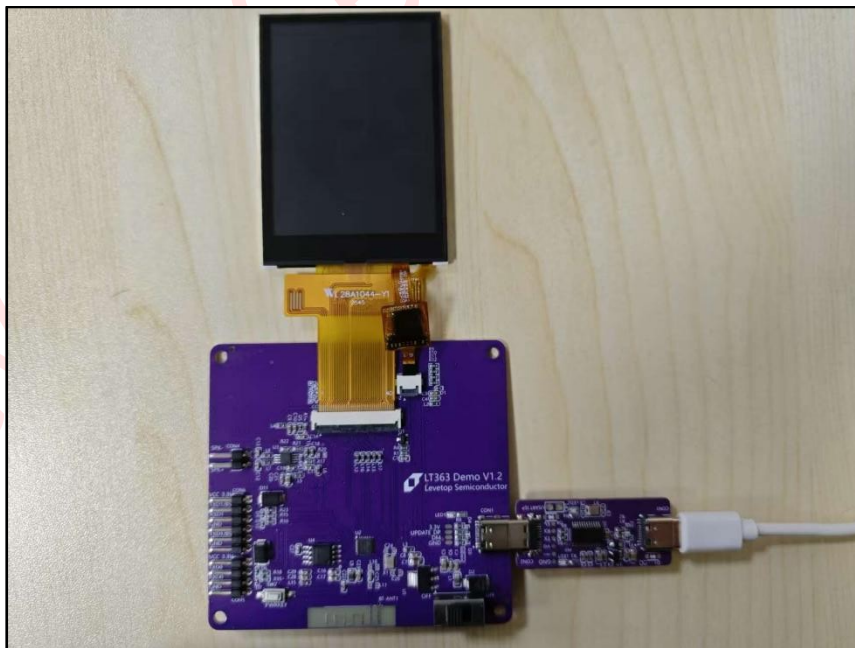
图 2-11: 将开发板、烧录器、USB 线与电脑连接
